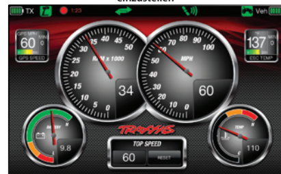
Das anpassbare Traxxas-Link-Armaturenbrett zeigt Daten für Drehzahl, Geschwindigkeit, Temperatur und Spannung in Echtzeit an.
